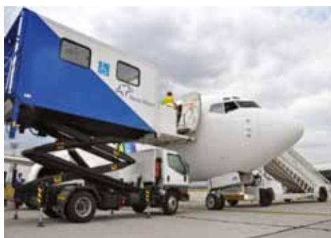
1. ábra. A beteget a repülőgép ajtajáig emelő kabin, 6 hordágy vagy 12 kerekesszék is elfér benne
