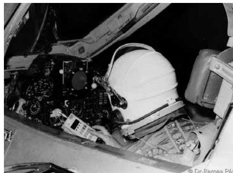
19. ábra. A ROVKI TL-8 típusú MiG-21-es repülőgép-szimulátorában, a hajózó Balatonon készülékkel méri az aktuális információ feldolgozó képességét
